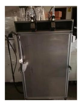
自动打孔机功能特点: 1、人性化操作界面,输入产品的孔位坐标参数即可进行产品加工,无需专业人员编程。2、控制系统:触摸屏操作界面+FATEK数字控制系统+伺服系统。3、加工范围广:通过更换模具可加
